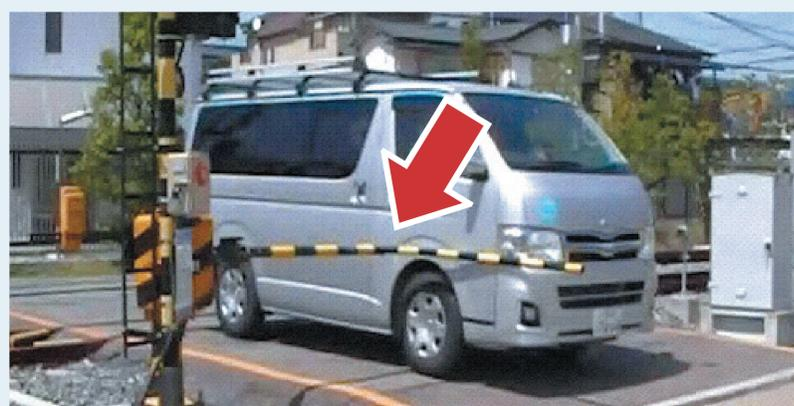
矢印部分が屈折して遮断桿への衝撃を分散。
